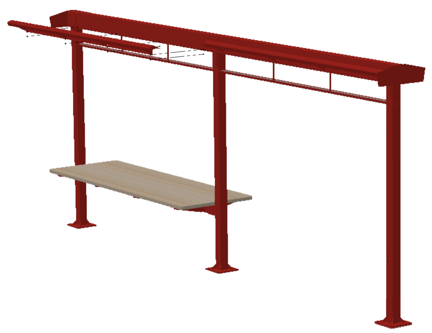
INFÄSTNINGSPLÅTARNA FÖR TAKSTOLARNA SKRUVAS MOT ÖVERLIGGAREN
