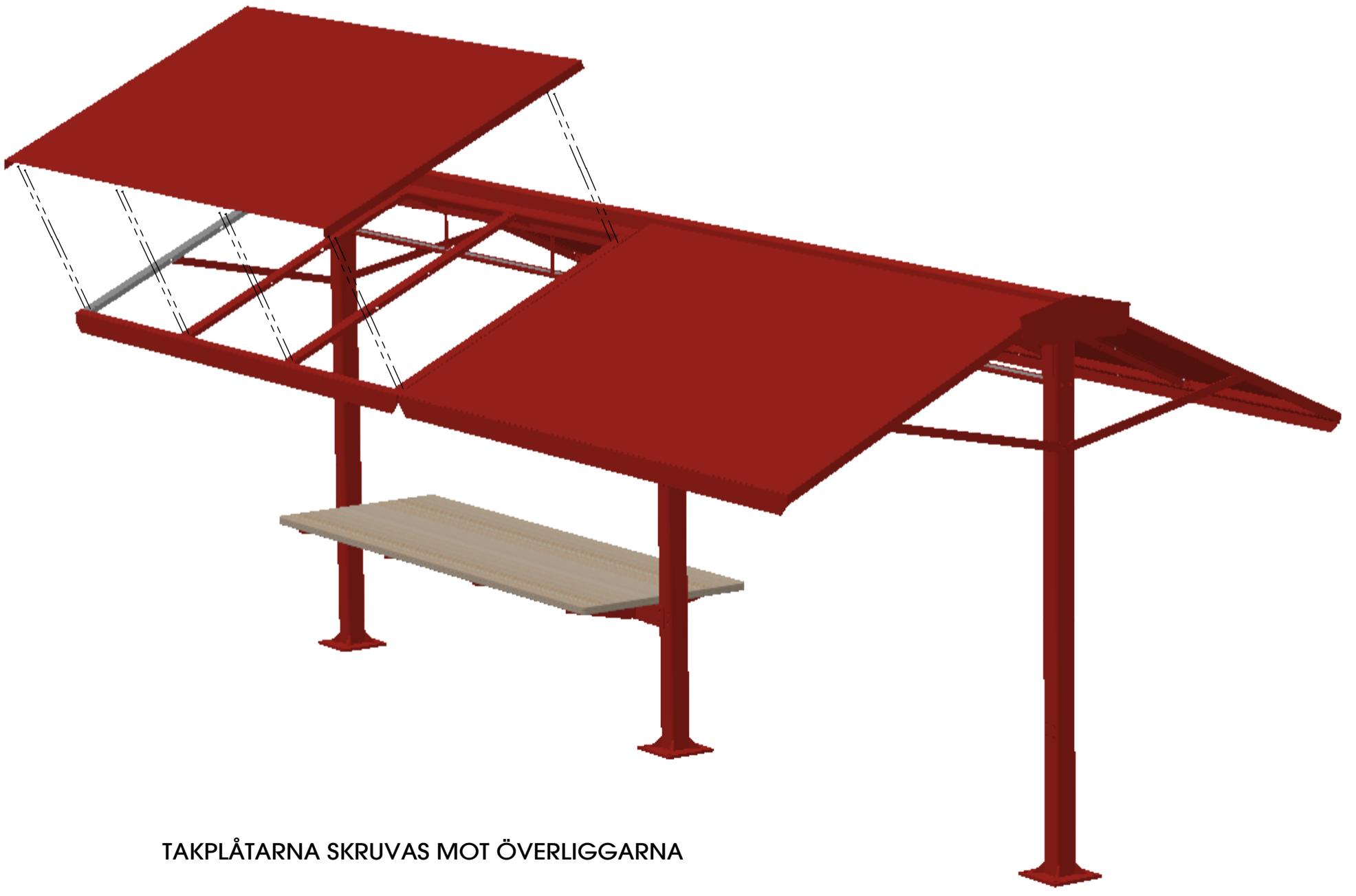
INFÄSTNINGSPLÅTARNA FÖR TAKSTOLARNA SKRUVAS MOT ÖVERLIGGAREN
